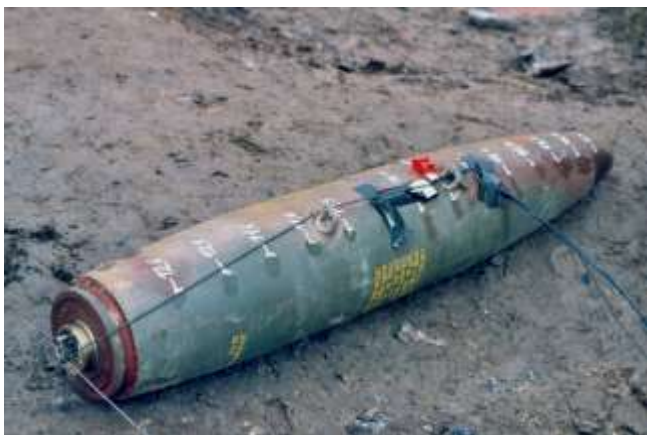
Vliegtuigbom US MK 82 500lbs General Purpose, voorbereid voor beschieting. (foto J.W. bewerking Eric de Wilde)
