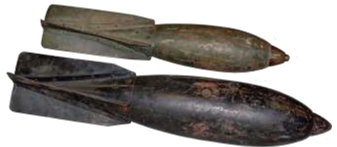
Nederlandse vliegtuigbommen van 8 en 25 kg. De staartvinnen staan onder een kleine hoek. Door de optredende draaiing tijdens de val, wordt de ontsteker gewapend. (foto: Eric de Wilde, collectie EODD)
