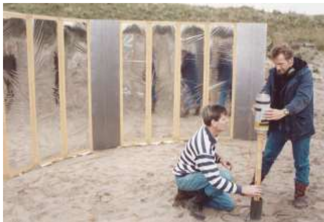
Vorbereiding arenatest met WDU 17/B warhead in centrum (Foto CvP *(6))
